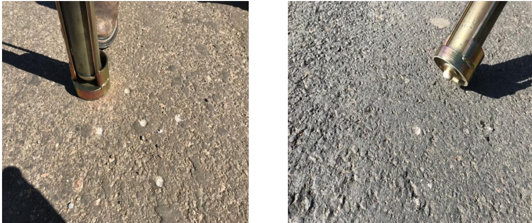
Figura 7. Ensayo de penetración en asfalto espumado (izquierda) y mezcla asfáltica (derecha).
