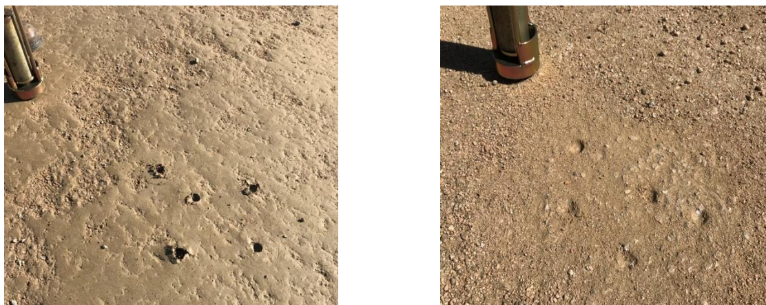
Figura 6. Ensayo de penetración en tosca cemento de 24 horas(izquierda) y tosca (derecha).
