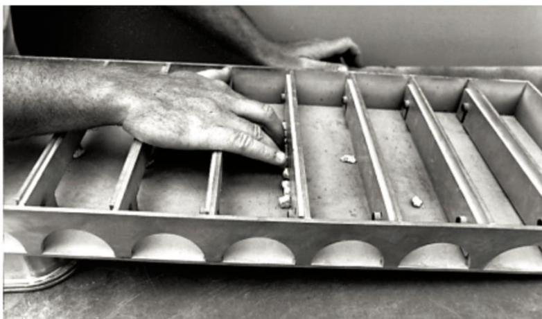
Figura 12. Bandeja ranurada para calcular el ALD de una muestra de áridos.
